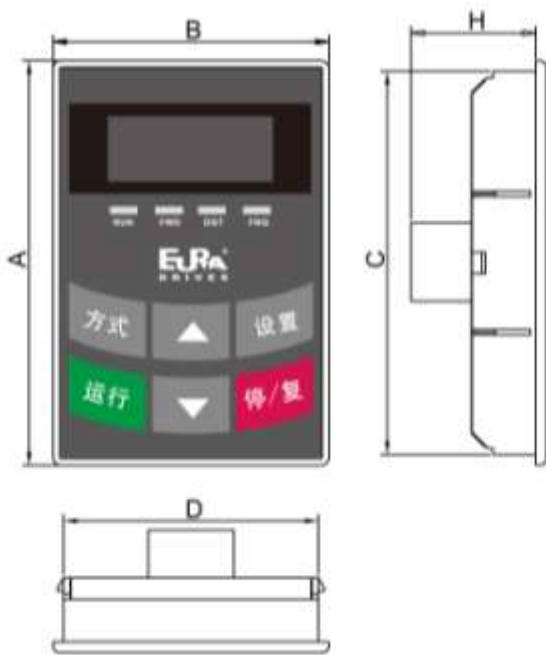
图 1-4 控制面板结构示意图
